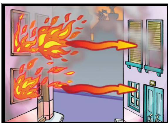
Fig. Propagação do Calor por Irradiação
